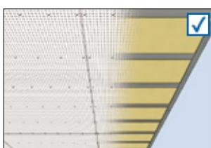
Rückseitige Mineralwollauflage, Dicke 30mm, direkt auf die Deckenplatten oder auf die Tragprofile auflegen.
