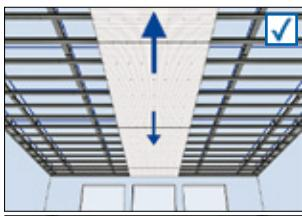
Zunächst werden die Deckenplatten in Richtung der Längsseiten, dann in der Querseiten-Richtung angebracht, so dass ein exaktes Kreuz an der Decke entsteht, anschliessend die verbleibenden Bereiche von der Raummitte aus nach gleicher Vorgehensweise montieren.
