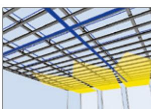
Ermitteln der Raummitte zum Platzieren der ersten Deckenplatte, dabei auch die sich ergebenden Randbereiche zu den Wandanschlüssen berücksichtigen. Die Plattenauflistung wird so gewählt, dass der Verschnitt möglichst gering wird und dass der Plattenquerstoss auf ein Tragprofil zu liegen kommt.
