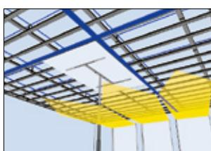
Die Verlegung der ersten Lochplatte beginnt in der Raummitte. Die erste Plattenreihe wird mit einem Schnurzschlag, Laser oder an einem unverrückbaren Anschlag wie zum Beispiel an einer Aluminiumlatte ausgerichtet und dann verschraubt. Bei der Ein-Mann-Montage mit Plattenheber (Plattenlift) oder alternativ mit Hilfe zusätzlicher Mitarbeiter, die Platte an die richtige Position der Unterkonstruktion bringen.
