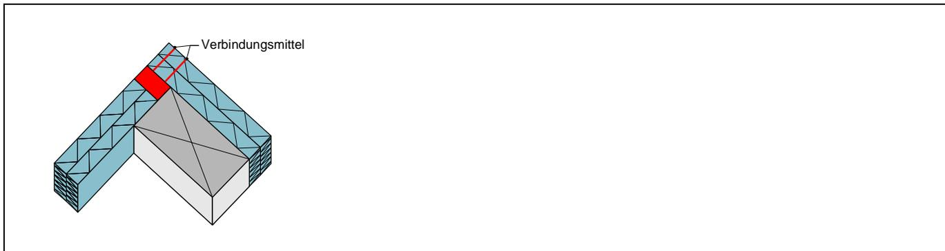
Abbildung 25: Mechanische Verbindung mehrerer nach aussen führender Bekleidungslagen
