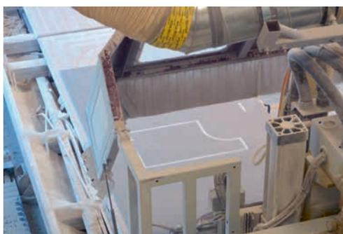
*Les plaques de plâtre et les éléments sont préfabriqués sur demande et aux dimensions exactes au moyen des machines CNC les plus modernes.*
