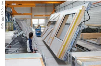
Les plaques de plâtre et plaques de plâtre fibrées gypsum4wood sont parfaitement appropriées pour la préfabrication.
