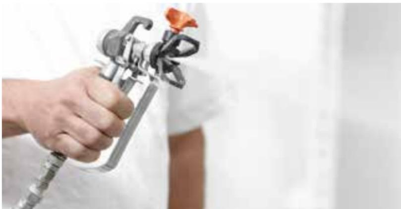
Le spatulage système Rigips® ProMix peut aussi être mis en œuvre à l'aide d'une machine, avec un vaporisateur approprié.
