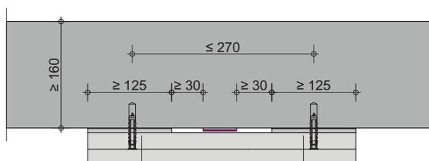
Revêtement de différentes armatures collées au-dessous de dalles en béton armé, 1<sup>re</sup> variante de montage (résistant au feu)
