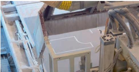
Gipsplatten und Formteile werden auf Wunsch mit modernsten CNC-Maschinen massgenau vorkonfektioniert.
