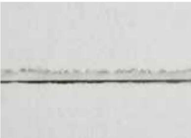
Gefaste Kante (obere Platte) an scharfe Schnittkante (untere Platte).
