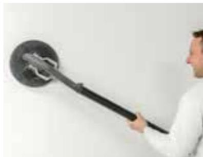
Falls erforderlich, kann die Oberfläche maschinell mit einem 120er- oder manuell mit einem 220er-Schleifpapier abgeschliffen werden.
