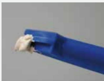
**5./6.** Die Rigiton® Fix Pistole etwas hochhalten und solange den Abzug betätigen, bis keine Luft mehr in der Kartusche vorhanden ist und das Rigips® Vario Fugenspachtelmaterial aus der Fugendüse ohne Unterbrechung austritt.
