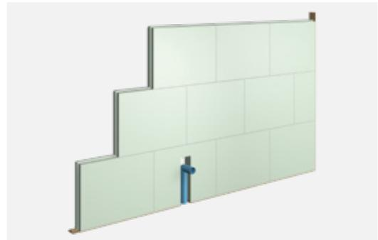
Systemaufbau Sanitärvorsatzschalen mit Alba® Vollgipsplatten
